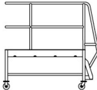
Plate-forme avec échelle et roulettes en option.
